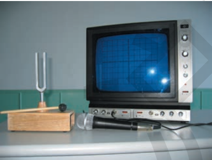
图 1-7 用示波器研究声振动
