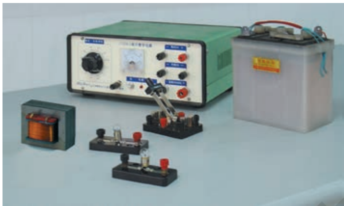
图 2-26 探究电感器对交变电流的阻碍作用
