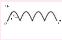
图 2-13 直流发电机发出的直流电波形
