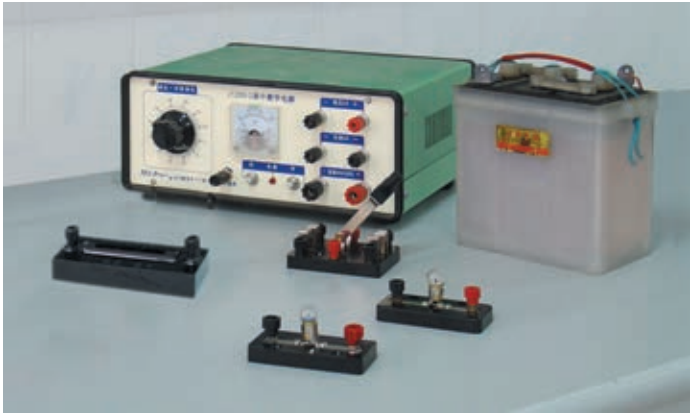
图 2-24 探究电阻器对交变电流的阻碍作用
