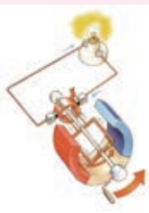
图 2-12 直流发电机示意图
