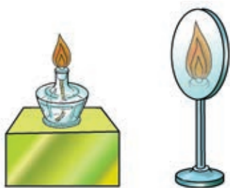
图 2-26 观察肥皂膜上光的干涉装置
