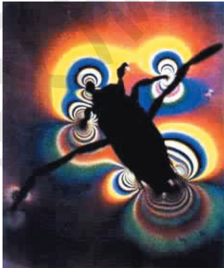
图 2-18 用偏振干涉仪观察水面上的昆虫,图中出现美丽的彩环是因为水面微斜发生干涉的结果
