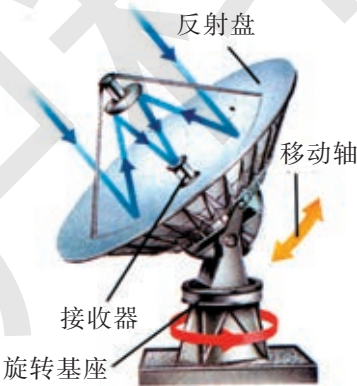
a 射电天文望远镜原理
