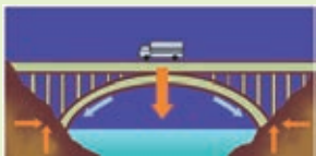
图 1-22 拱桥受力分析示意图
