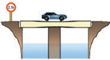
图 1-18 有桥墩的梁桥
