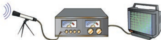
图 2-5 用示波器观察声波波形
