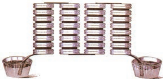
图 2-4 伏打的电堆是一连串用弄湿的布垫片隔开的金属圆板
