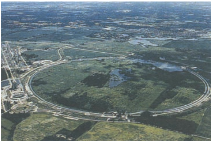
图 2-51 美国费米实验室的回旋加速器,直径达 2km
