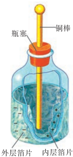
图 1-9 莱顿瓶的结构
