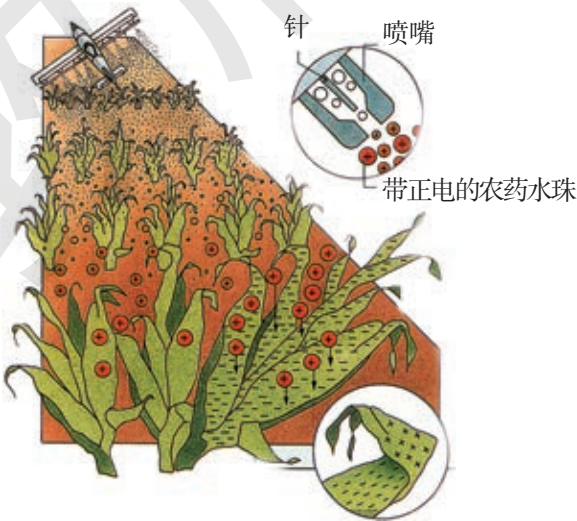
图 1-3-5 利用静电喷洒农药示意图
