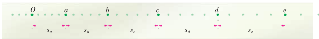
图 1-37 打点计时器记录的小车做匀变速直线运动的点迹
