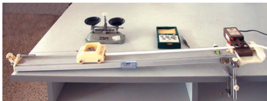
图 1-36 测量匀变速直线运动加速度的实验装置
