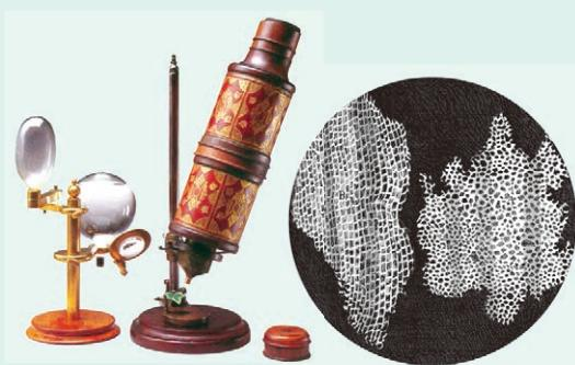
图 1-3 胡克制作的显微镜
